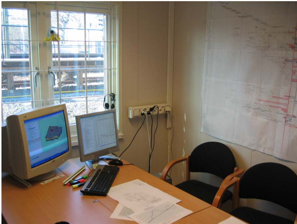
Figur 7: Användning av 4D-modellen på arbetsplatsen. Planeringen (på väggen och på den högra skärmen) länkas till 3D-modellen som resulterar i en 4D-modell (vänstra skärmen)
